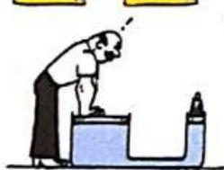
۲۲. در چک هیدرولیک مقابل، مساحت پیستون بزرگتر  $50$  برابر مساحت پیستون کوچکتر است. شخص مورد نظر باید چه نیرویی وارد کند تا بتواند مانع پایین آمدن وزنه  $10$  کیلوگرمی شود.
