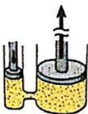
۲۳. اگر در یک چک هیدرولیک، شاعع پیستون کوچکتر  $2$  سانتی‌متر و شاعع پیستون بزرگتر  $4$  سانتی‌متر باشد، با استفاده از این چک مقدار نیروی وارد بر پیستون کوچکتر چند برابر می‌شود؟
