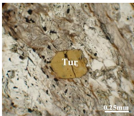
شکل ۲: تصویر مقطع میکروسکوپی (PPL)، تورمالین (Tur) موجود در هورنفلس.
