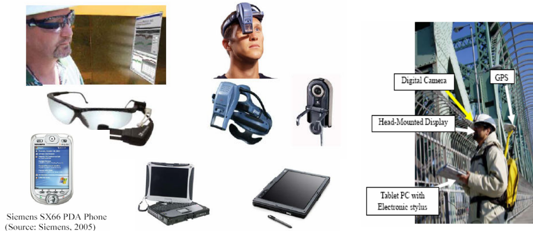
شکل ۷: نمونه ای از وسایل سیار مورد استفاده در بازدید پل ها
