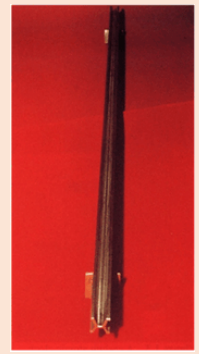
میله ای از آلیاژ پلاتین ایریدیوم به نام متر استاندارد
