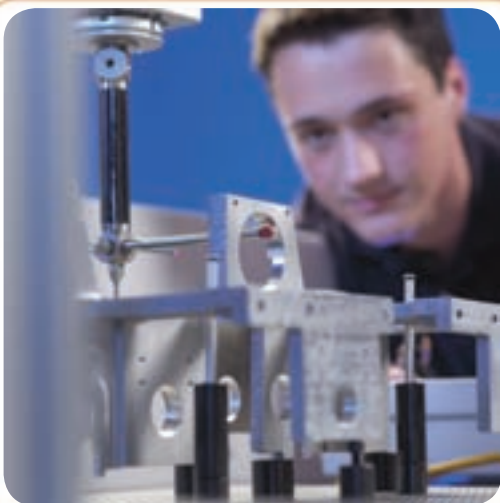
متخصصان اندازه گیری دقیق به کمک دستگاه های پیشرفته و حساس، اندازه دقیق قطعه را پس از تولید با اندازه مورد نظر طراح که روی نقشه درج شده است، مقایسه می کنند.
