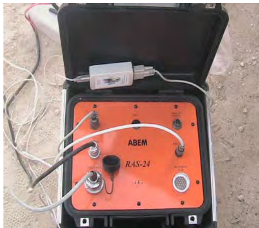
شکل (۱۰): شمایی نزدیک از صفحه دستگاه لرزه‌نگار RAS 24
