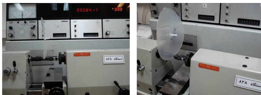
شکل ۴- اندازه گیری انقباض در جهت ضخامت با استفاده از دستگاه اندازه گیری انیورسال 828 NE MAHR
