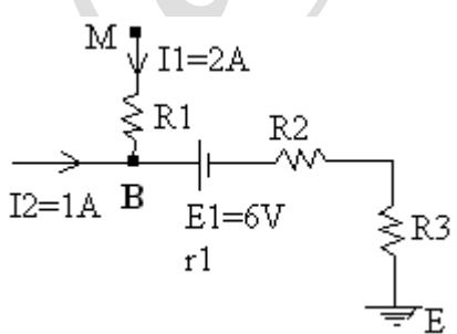
ب) توان گرمایی در مقاومت  $R_2$  را بدست آورید.
