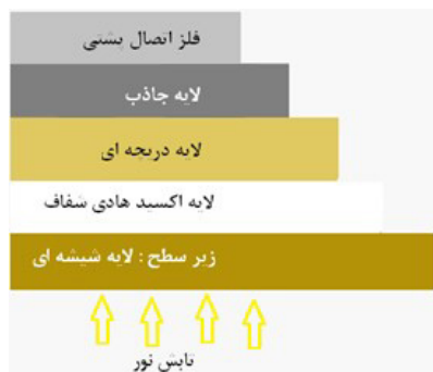
شکل ۱: ساختار اولیه برای یک سلول خورشیدی لایه نازک
