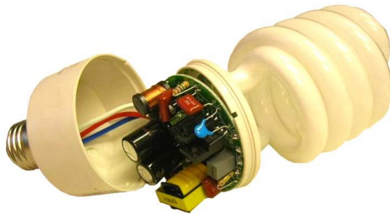
شکل ۶۳- مدار داخلی یک نمونه لامپ کم مصرف
