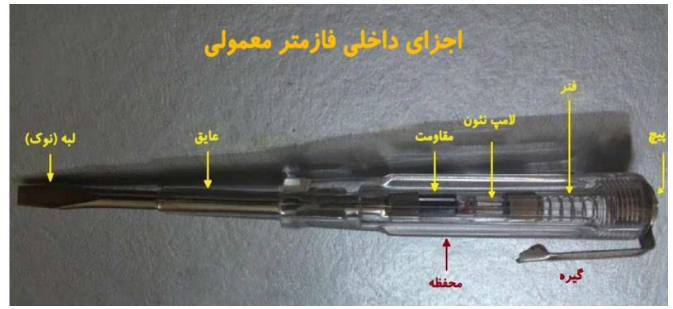
شکل ۲-۳۷- ساختمان داخلی فازمتر
