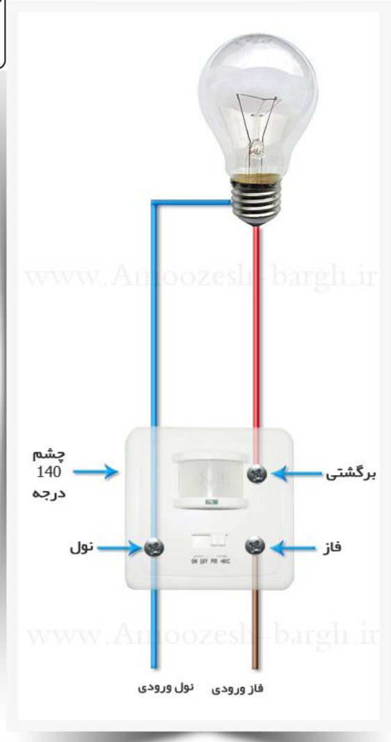
شکل ۷۱-۲ یک نمونه نقشه رله چشمی راه پله
