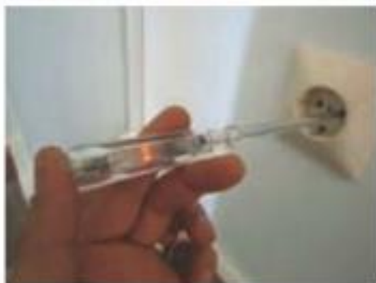
شکل ۲-۳۶- نمایش ولتاژ با استفاده از فازمتر
