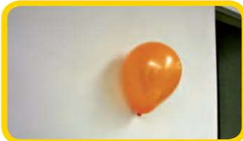
شکل ۱- بادکنک دارای بار الکتریکی به دیوار می‌چسبد.
