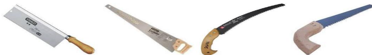
قسمت های تشکیل دهنده: ۱-دسته ۲-تیغه ۳-پیچ ها و مهره های نگهدارنده ی تیغه در دسته.
