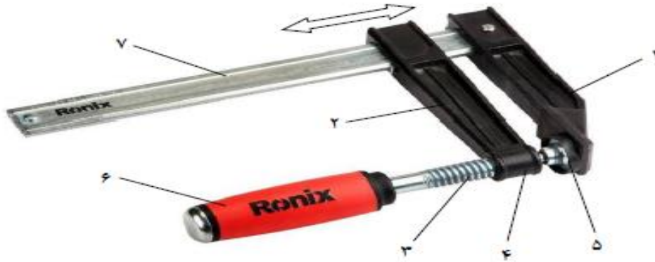
قسمت های تشکیل دهنده: ۱- فک ثابت ۲- فک متحرک ۳- پیچ تنظیم ۴- مهره ی پیچ تنظیم ۵- بشقابک هرزه ۶- دسته ی پیچ گردان ۷- ریل فک متحرک.
