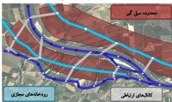
شکل ۶- نمایش شماتیک نحوه مدل‌سازی شبه دوبعدی سیلاب با استفاده از کانال‌های ارتباطی
