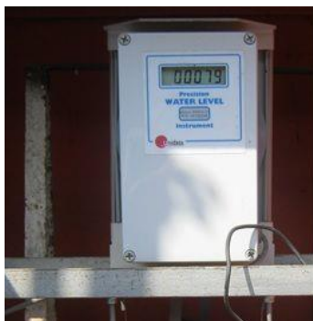
شکل ۵- نمونه دستگاه‌های سطح‌سنج الکترونیکی با سنسور شفت انکودر منصوب در
