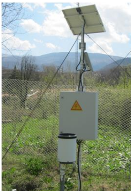
شکل ۴- نمونه‌ای از دستگاه‌های باران‌سنج با فناوری وزنی (سمت راست بالا) و راداری (سمت راست پایین) و نیز دستگاه با فناوری تیپینگ باکت نصب شده در ایستگاه پارک ملی گلستان (سمت چپ)
