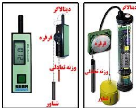
شکل ۵- نمونه دستگاه‌های سطح‌سنج الکترونیکی با سنسور شفت انکودر منصوب در
