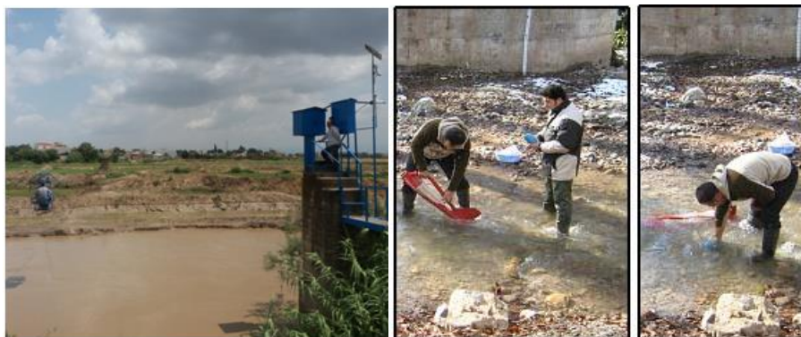
شکل ۱- اندازه‌گیری سیلاب در ایستگاه هیدرومتری آرازکوسه با استفاده از دستگاه مولینه (سمت چپ) و اندازه‌گیری رسوب معلق و بار کف با استفاده از دستگاه هلی-اسمیت (سمت راست)
