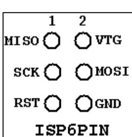
ولتاژ سیستم شما تغذیه شود. این کار ساده ایست و نیاز به دو خط اضافی بین برنامه ریز و بورد AVR دارد. GND همان زمین عمومی و VTG (Target Voltage) ولتاژ ورودی (معمولأ ۵ ولت) است. با انجام این کار مجموعاً ۶ خط بین برنامه ریز و بورد AVR وجود خواهد داشت. اتصال ISP6 نهایی، براساس تعریف شرکت ATMEL، در سمت چپ نشان داده شده است.
