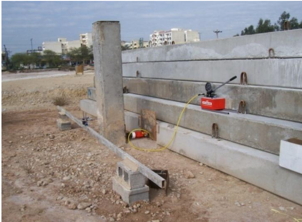
شکل الف-۲۲- تست بارگذاری استاتیکی جانبی
