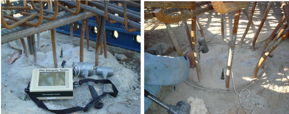
شکل الف-۱۸- تجهیزات تست کنترل یکپارچگی شمع PIT
