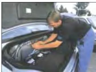
مفزن گاز هیدروژن در هندوق عقب فوروها نصب می‌شود.
