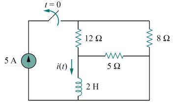
در مدار زیر  $i_o$  و  $i_o$  را برای تمامی زمان ها تعیین کنید.-۵
