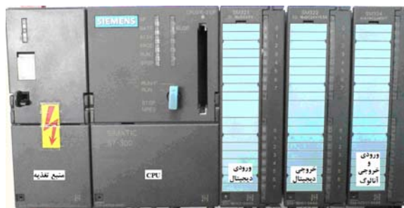
شکل (۱-۳) تصویر ماژول‌های یک PLC بر روی ریل
