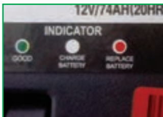
چ - در باتری سیلد سلامت باتری بر اساس سه نوع رنگ مشخص می‌شود.
