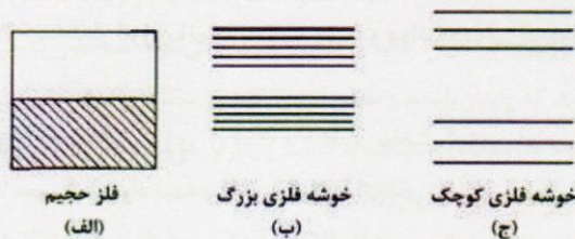
شکل ۱-۴- الف) ساختار انرژی ماده معمولی به شکل نوار انرژی، ب) ساختار انرژی نانو ذرات بزرگ و ج) ساختار انرژی نانو ذرات کوچک
