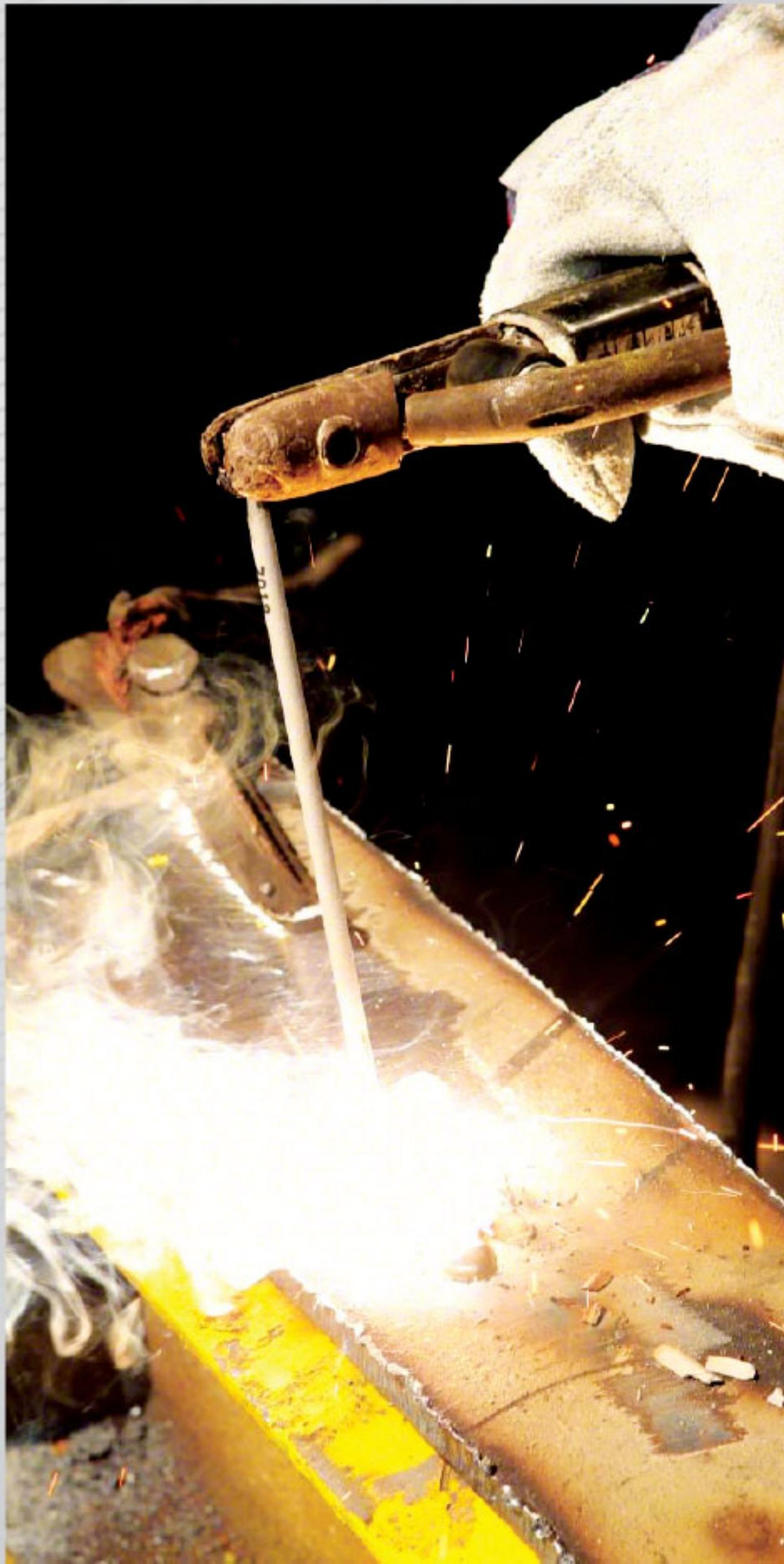
در جوشکاری قوس فلزی با الکترود پوشش دار (Shielded Metal Arc Welding: SMAW) قوس الکتریکی بین یک الکترود روکش دار و قطعه کار زده می شود و در نتیجه حرارت لازم برای ذوب کردن فلز پایه و الکترود تأمین می شود. در این فرآیند از مکانیزم فشار استفاده نمی شود. وظیفه محافظت از حوضچه مذاب در این فرآیند بر عهده پوشش الکترود می باشد که این پوشش در هنگام جوشکاری در اثر حرارت تجزیه شده و به صورت سرباره و گاز از فلز جوش محافظت می کند.
