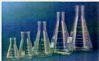
ارلن مایر یک ظرف مخروطی با گردن نسبتاً باریک در حجم‌های مختلف است. از اrlen مایر معمولاً برای مخلوط کردن و حتی نگهداری مایعات و یا به عنوان جمع‌کننده محصول تقطیر در عمل تقطیر و یا جمع‌کننده مایع خارج شده از قیف جداکننده در هنگام عمل استخراج نیز استفاده می- شود.
