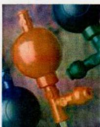
در هنگام استفاده از آن باید به این نکات توجه کرد که باید پیپت را طوری در دست گرفت که بتوان توسط انگشت اشاره دهانه آن را گرفته تا میزان حجم مایع داخل آن قابل کنترل باشد و نیز برای برداشتن محلول‌های سمی و خطرناک نظیر محلول‌های اسیدی، محلول‌های قلیابی و ... باید حتماً توسط پیپت پرکن، پیپت را پرکرده و به کمک آن میزان محلول داخل پیپت را کنترل کرد.
