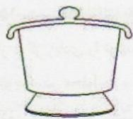
۱۰- دسیکاتور (خشکانه): از این وسیله که شبیه یک قابلمه بزرگ شیشه‌ای است بیشتر برای گرفتن رطوبت و خشک کردن مواد استفاده می‌شود و چون این وسیله رطوبت موجود در مواد را توسط مواد جاذب الرطوبه‌ای مانند کلرید کلسیم و یا اسید سولفوریک غلیظی که در ظرف پایین آن قرار دارد جذب می‌نماید. پس نباید درب آن را به مدت طولانی باز گذاشت زیرا در غیر این صورت رطوبت موجود در محیط آزمایشگاه جذب مواد جاذب الرطوبه آن شده و موجب کاهش کارآیی دستگاه می‌شود.
