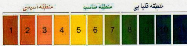
کاغذ تورنسل: به صورت نوار کاغذی باریکی به فروش می‌رسد که با فرو بردن این کاغذ در آب، در صورت قلیایی بودن آب (pH بیشتر از 7) به رنگ آبی در آمده و در صورت اسیدی بودن آن (pH کمتر از 7) به رنگ قرمز در می‌آید.
