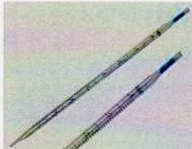
از این وسیله بیشتر برای برداشتن حجم دقیقی از مایعات استفاده می‌شود که دارای دو نوع مدرج و حباب‌دار بوده و هر دو نوع اندازه‌های حجمی دارند که البته نوع مدرج آن کاربرد بیشتری دارد چون توسط نوع مدرج می‌توان به هر اندازه دلخواه مقداری از محلول‌ها را سنجیده و برداشت. ولی توسط نوع حباب‌دار تنها یک حجم از پیش تعیین شده قابل برداشت می‌باشد که میزان حجم در نوع حباب‌دار معمولاً بر روی حباب آن نوشته شده است و محدوده آن توسط خطی که بر روی لوله بالای حباب وجود دارد تعیین می‌شود.
