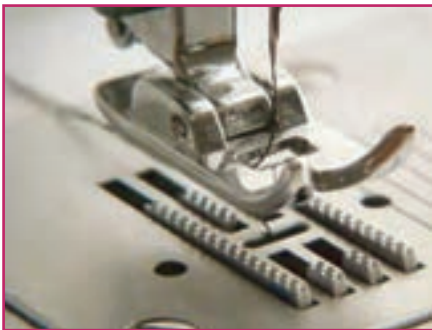
ب- ساز و کار حرکتی شانه (دندان) کار پیش بر ماشین دوخت
