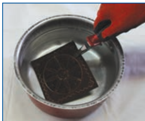
شکل ۱۰-۱۲- سرد کردن پلاک مسی آغشته به قیر با آب
