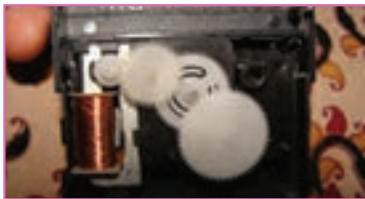
ب- بعد از باز کردن موتور ساعت
