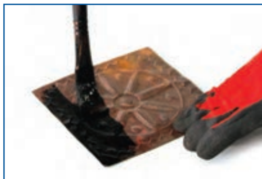
شکل ۱۰-۱۰- آغشته کردن سطح پلاک مسی به قیر
