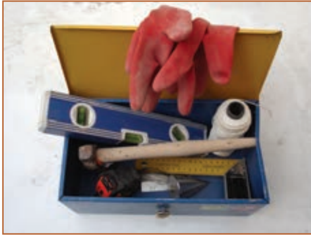
شکل ۱۰-۷- برخی از ابزار مورد نیاز دیوار چینی
