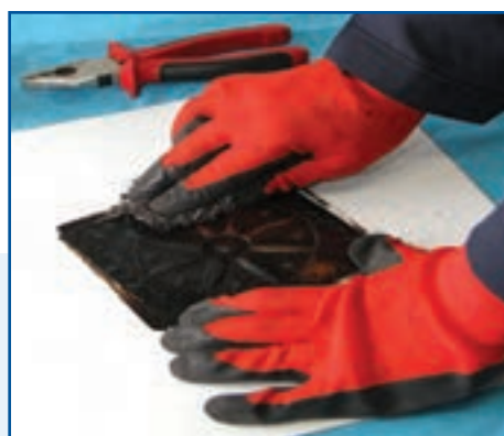
شکل ۱۰-۱۳- ساب زدن سطح پلاک مسی
