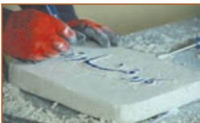
شکل ۲۳-۷ کنده کاری قطعه گچی
