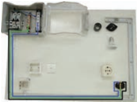
شکل ۱۰-۵- انجام سیم‌کشی پریز ۱
