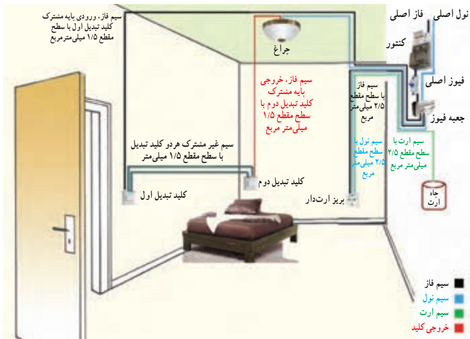
شکل ۱۸-۵ - سیم‌کشی مدار کلید تبدیل
