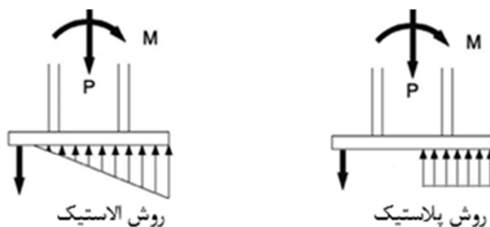
شکل (7): روش الاستیک و پلاستیک برای تعیین تنش های اتکایی بتن
