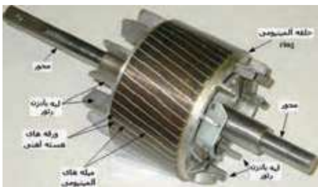
شکل ۲۱- ساختمان رتور قفسی (سمت راست) رتور کامل با معرفی اجزای آن (سمت چپ)
