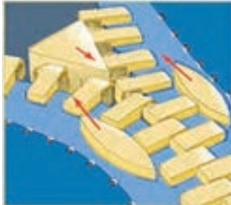
زیب نمونه‌ای از فن‌آوری قرن بیستم است که از سه گوه بهره می‌برد. دسته زیب از گوه‌هایی تشکیل شده که تلاش کوچک ما را به نیروی بزرگی تبدیل می‌کنند که زیب را باز می‌کند و می‌بندد. بدون کمک این گوه‌ها، متصل کردن یا جدا کردن دندان‌های زیب تقریباً امکان‌پذیر نیست.
