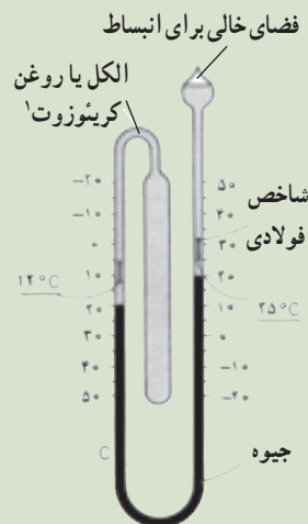
شکل ۶-۳- طرح واره ای از یک دماسنج بیشینه - کمینه و شکلی واقعی از یکی از انواع آن
