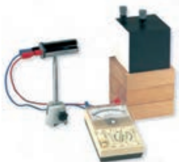
شکل ۶-۲۰- درون مکعب لایسی آب داغ می ریزند. تابش گرمایی از چهار وجه جانبی مکعب، که رنگ های متفاوتی دارند، با هم فرق دارد.
