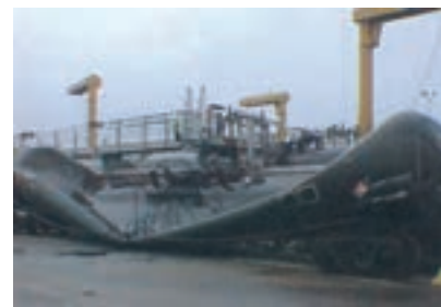
شکل ۲۲-۶- سرد شدنِ هوای درون مخزن باعث کاهش فشار این هوا و در نتیجه میخاله شدن مخزن شده است.
