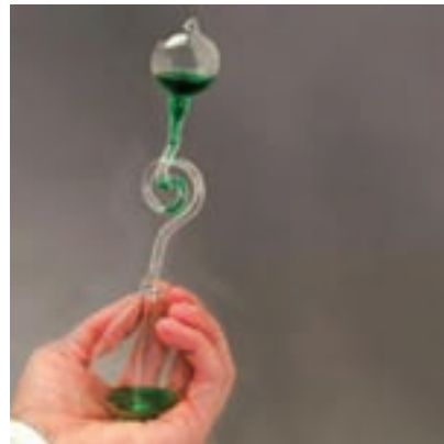
شکل ۲۳-۶- با در دست گرفتن جاب شیشه ای و گرم کردن آن، مایع رنگی لوله ماریچ بالا می رود.
