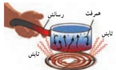
شکل ۶-۹- در این شکل، هر سه روش انتقال گرما را در تصویری مشاهده می‌کنید.
