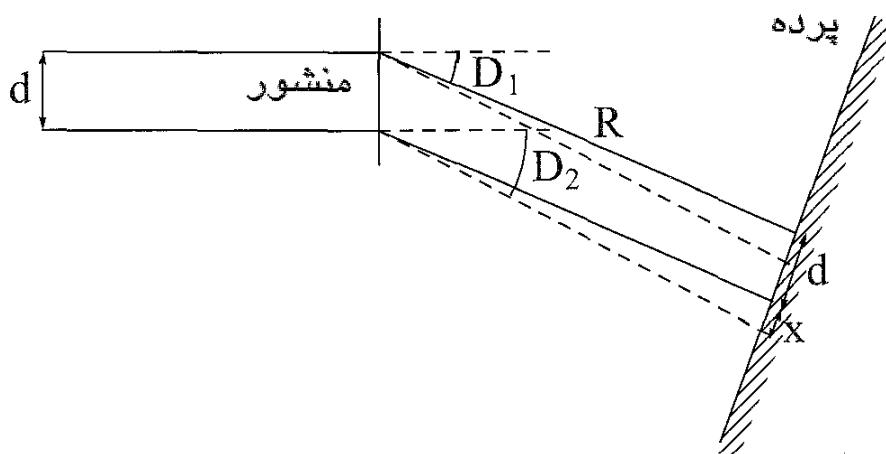
دو پرتویی که از لبه بالایی شکاف گسیل شده، روی پرده به اندازه  $x$  از یکدیگر فاصله می‌گیرند. برای این که دو نور کاملاً از هم تفکیک شوند، باید  $d > x$  شود. بنابراین ابتدا  $x$  را محاسبه می‌کنیم.
