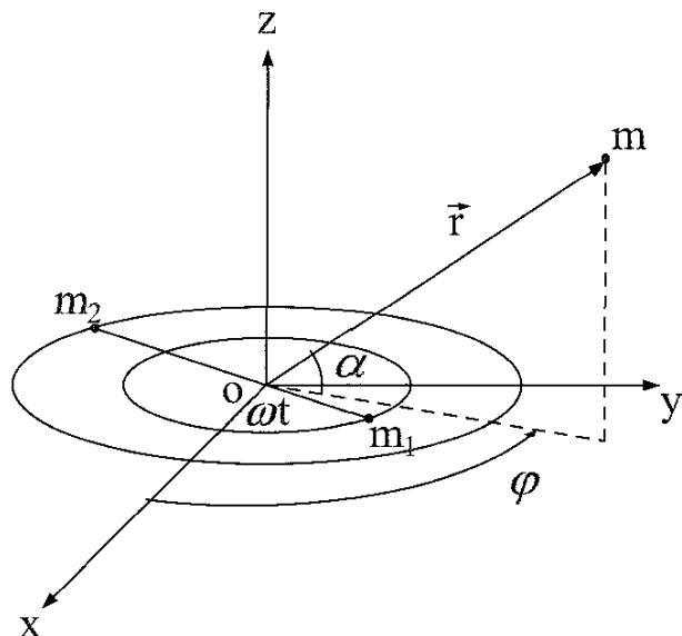
اجرام  $m_1$  و  $m_2$  حول نقطه  $O$  با سرعت زاویه‌ای  $\omega$  دوران می‌کنند و بردار مکان آنها در دستگاه  $xyz$  به صورت  $\vec{d}_2 = -d_2(\cos \omega t \hat{i} + \sin \omega t \hat{j})$  و  $\vec{d}_1 = d_1(\cos \omega t \hat{i} + \sin \omega t \hat{j})$  است. بردار مکان جرم  $m$  هم به صورت  $\vec{r} = r(\cos \alpha \cos \varphi \hat{i} + \cos \alpha \sin \varphi \hat{j} + \sin \alpha \hat{k})$  است. سیاره تقریباً ثابت است پس داریم:
