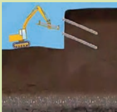
پایدارسازی شیب به روش میخ کوبی
