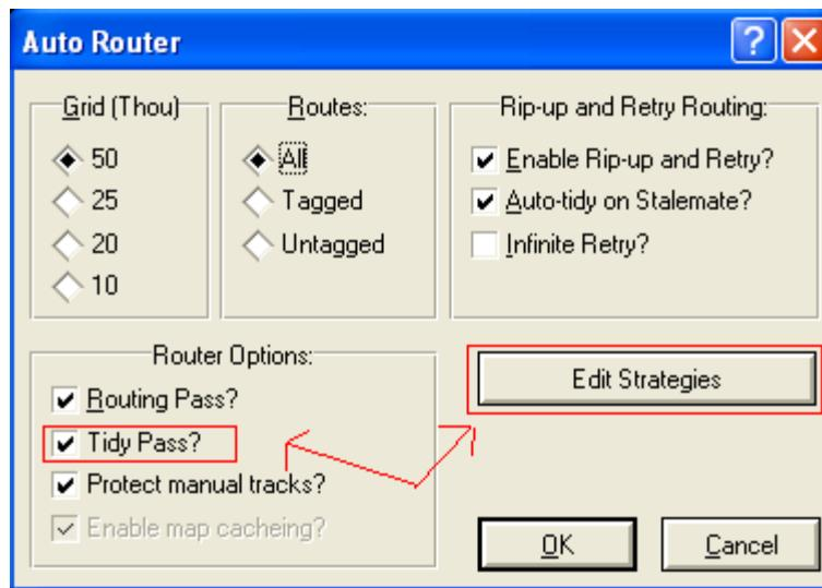
در قسمت Edit Strategies دو نوع تنظیمات وجود دارد ، تنظیمات خطوط power vcc و گراند ( و تنظیمات خطوط single ) عادی ، در زیر تنظیمات مربوط به power را بررسی میکنیم ( هر دو قسمت کاملا مشابه هم میباشند ) :
