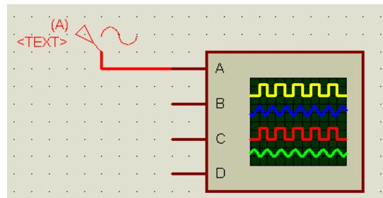
مقدار فرکانس منبع 10 هرتز و ولتاژ دامنه ان (Amplitude) 5 ولت باشد . شبیه سازی را اغاز کنید ، مشاهده میکنید که پانل
