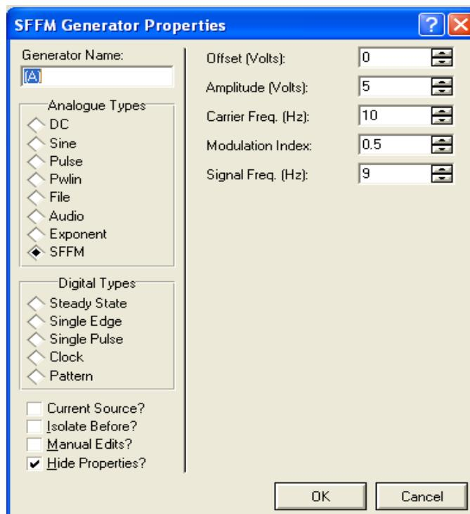
در پنجره بالا offset مقدار سطح dc اضافه شده به ولتاژ است همچنین amplitude دامنه ولتاژ هر دو شکل موج را مشخص میکند.
