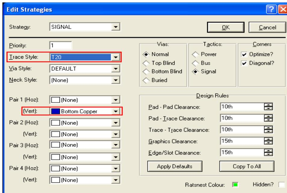
و در هر دو پنجره بر روی ok کلیک کنید ، مسیر کشی شروع میشود ، ممکن در طول عملیات پیغام های مبنی بر ذخیره گزارش و... ظاهر شود ، برای هر مورد کار لذخوار را انجام دهید . بعد از اتمام سیم کشی ، در صورتی که در گوشه پایین ، سمت چپ نرم افزار پیغام خطای وجود نداشته باشد ، کار طراحی تمام است.
