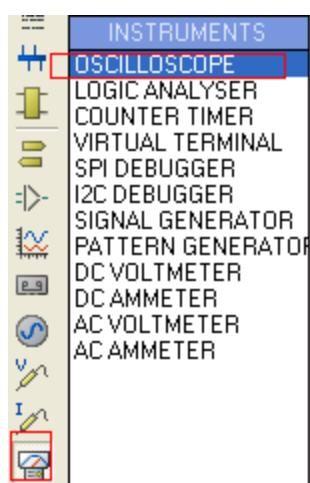
از پانل generators یک منبع ولتاژ سینوسی بیاورد و ان را به کانال a اسیلوسکوپ متصل کنید :
