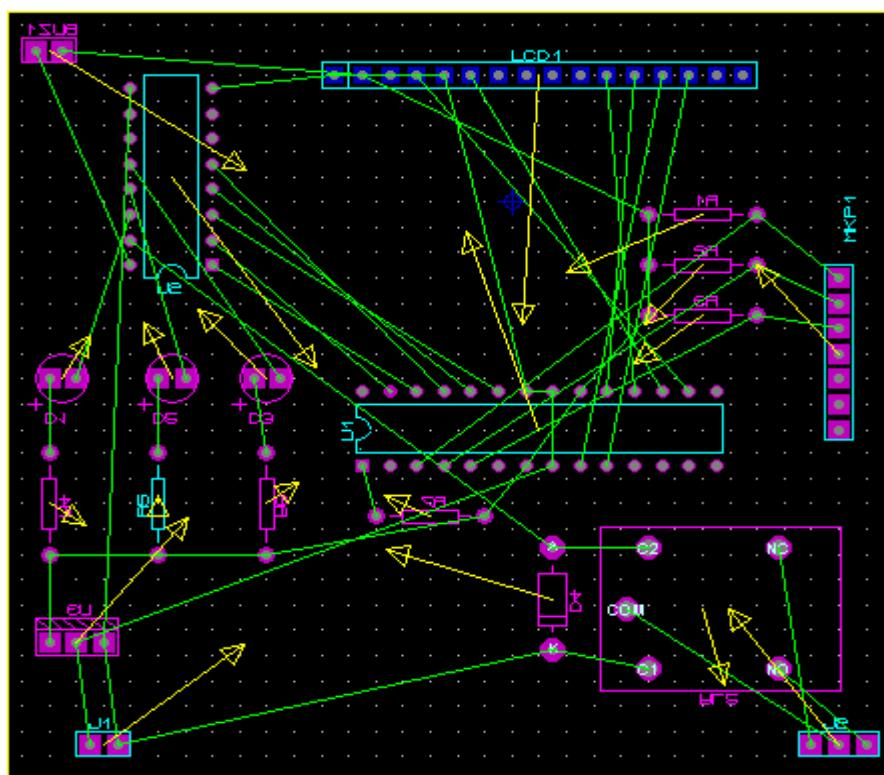
در این نرم افزار نیز مانند پروتول میتوانید از چیدمان اتوماتیک استفاده کنید ، برای این کار از منوی Tools گزینه‌ی Auto Placer را انتخاب کنید ، در پنجره‌ای که با انتخاب این گزینه باز می‌شود ، میتوانید معین کنید که کدام قطعات در چیدمان خود کار وجود داشته باشند و فاصله بین انها چقدر باشد . بعد از اعمال تنظیمات روی ok کلیک کنید ، مشاهده میکنید که قطعات در کمترین فضای ممکن چیده میشوند .
