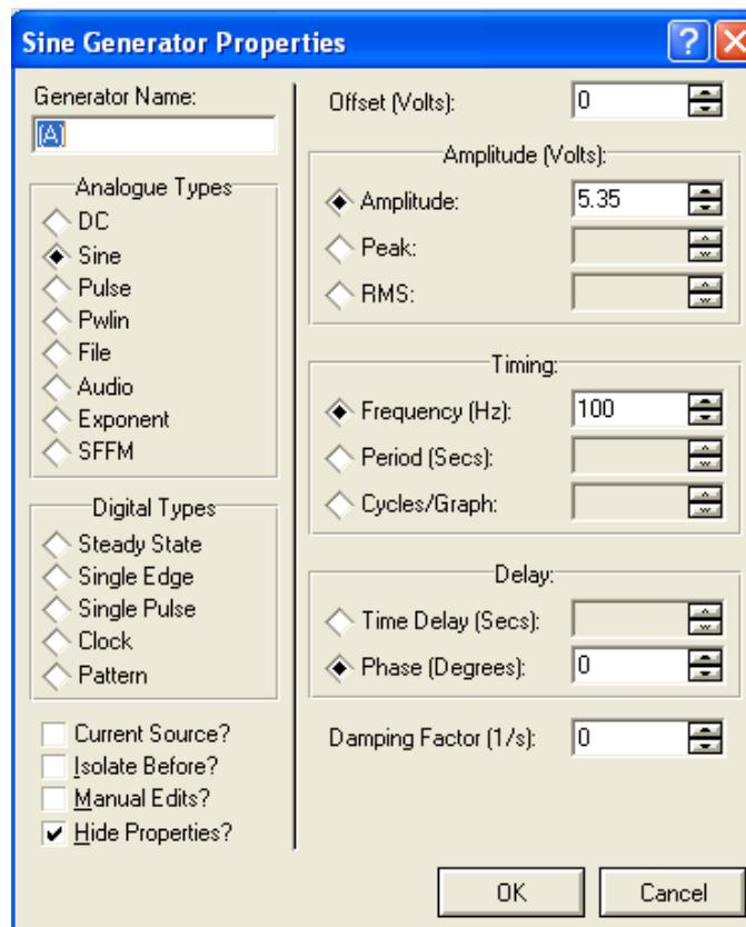
مقدار موجود در شکل بالا را وارد کنید و شبیه سازی را اغاز نمایید مشاهد میکنید که شکل موجی با فرکانس 100 هرتز و ولتاژ 5.35
