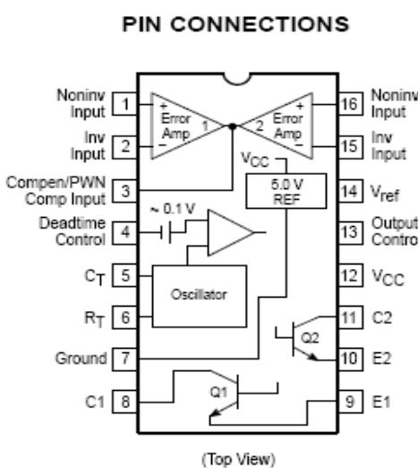
ای ایسی که در منابع تغذیه سویچینگ کاربرد دارد ، تهیه کننده پالس pwm برای راه اندازی ترانزیستور های قدرت میباشد دیتا شیت
