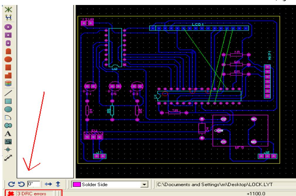
در مدار بالا چند مسیر وجود دارد که نرم افزار نمیتواند انها را رسم کند ، برای رسم این مسیر ها باید از مسیر کشی دستی استفاده شود
