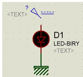
سپس ان را با سیم به مدار متصل کنید (موس را روی نقطه مورد نظر از مدار ببرید (مثبت led)، هنگامی که ایکون فلاش موس به مداد تبدیل شد، بر روی نقطه کلیک کنید و مسیر را تا منبع ادامه دهید):
