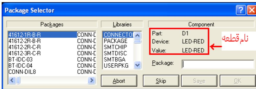
در صورتی که با پیغام زیر روبرو شدید مدل pcb انتخاب شده مناسب قطعه نمیباشد و شما باید یک مدل pcb دیگر را انتخاب کنید
