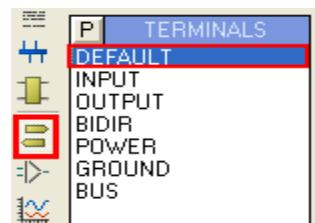
برای استفاده از این نوع ترمینال ، قطعات مورد نیاز را در مکان مناسب در صفحه شماتیک قرار دهید ، سپس در این منو بر روی کلیک نمایید و دوباره بر روی پایه مورد نظر کلیک کنید. این کار را برای تمامی پایه ها انجام دهید:
