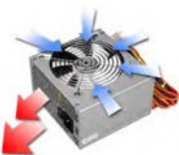
شکل ۹-۲۳- جهت تهویه هوا در منبع تغذیه
