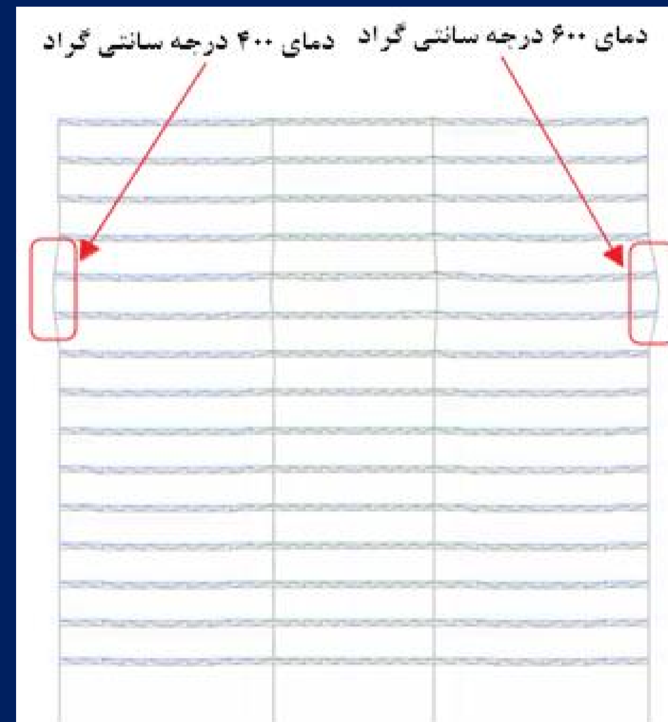
وضعیت تغییر شکل خرپاها و ستون ها در دمای ۶۰۰ درجه سانتی گراد
