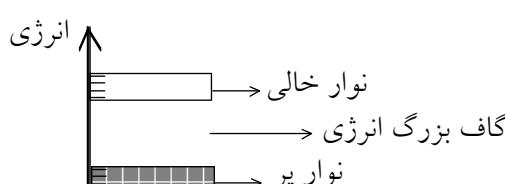
در این مواد نوارها یا کاملاً پر هستند و یا کاملاً خالی هستند. در این حالت الکترون‌ها نمی‌توانند بین ترازهای انرژی در یک نوار انرژی جابه‌جا شوند. از طرفی گاف انرژی در آن‌ها آنقدر بزرگ است که امکان عبور از آن وجود ندارد. پس الکترون‌ها نمی‌توانند در هیچ حالتی تراز خود را تغییر دهند و در رسانش شرکت نمایند.
