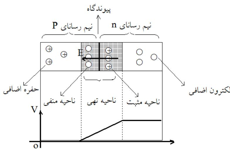
باشد. (به همین علت این ناحیه، ناحیه‌ی تهی نامیده می‌شود) با جابه‌جایی حفره‌ها و الکترون‌ها، در طرف P تعدادی الکtron و در طرف n تعدادی بار مثبت مستقر می‌شود.
