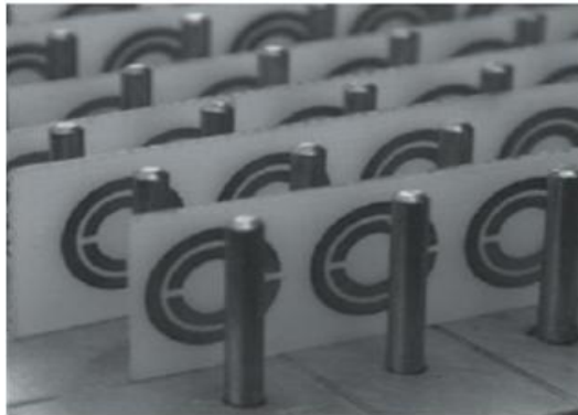
شکل ۲: آرایه پیشنهادی برای محیط با ضریب شکست منفی
