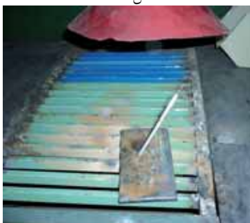
شکل ۴-۸b، الکتروود چسبیده به قطعه کار
