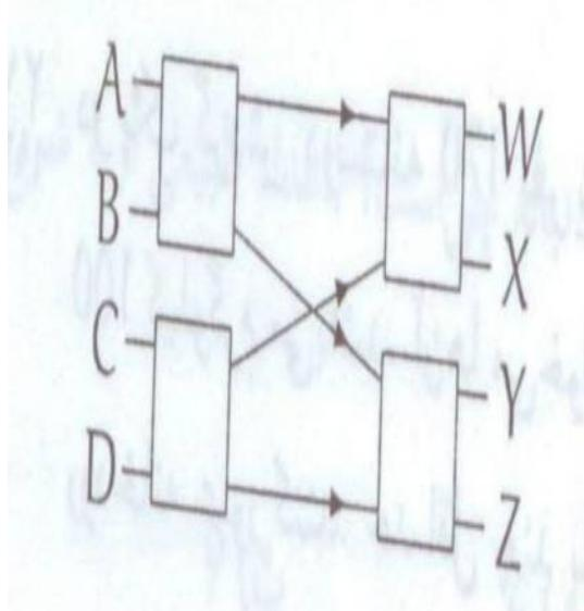
۱۶A) در شکل رو برو هر یک از مربع‌ها یک کلید است که می‌تواند دو وضعیت مختلف داشته باشد: یا ورودی‌ها را به صورت مستقیم به خروجی انتقال دهد، و یا آن‌ها را جابه‌جا کند؛ یعنی ورودی بالا را به خروجی پایین بفرستد و ورودی پایین را به خروجی بالا.
