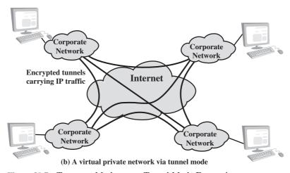
**Figure 20.7** Transport-Mode versus Tunnel-Mode Encryption
