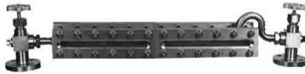
49-2: اندازه‌گیری سطح مایعات با استفاده از آب‌نما
