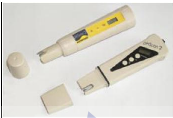
شکل (6): دستگاه سنجش مقدار PH آب
