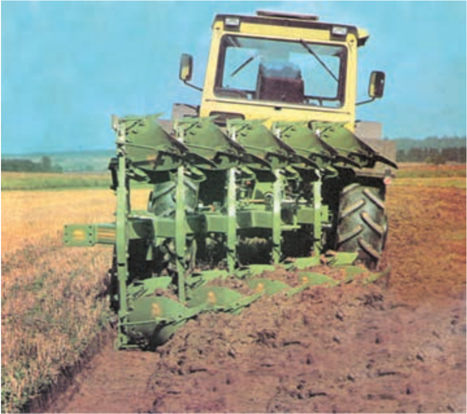
شکل ۵-۱- شخم با گاو آهن برگردان‌دار برای برگرداندن یونجه‌زار
