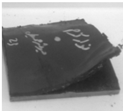
شکل ۷- نمونه ی رد شده ی نوار گرم بیتومنی روی سرجوش
