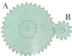
(A) چرخ دنده ورودی در جهت ساعتگرد و B چرخ دنده خروجی است
