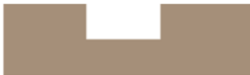
شکل ۲۷- کاهش ضخامت پی در محل چاهک آسانسور
