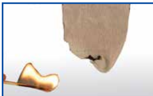
شکل ۵-۸ - سوختن پارچه از جنس پلی استر
