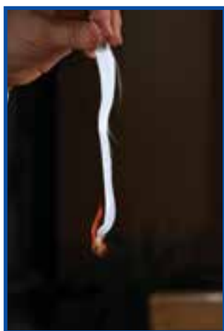
شکل ۸-۴ سوختن پارچه استات
