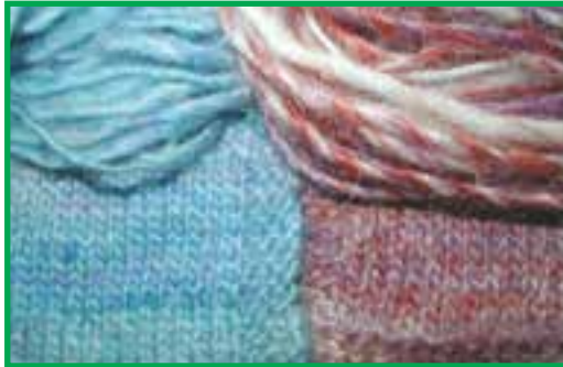
شکل ۳-۷- نخ با تاب کم و پارچه بافته شده از آن
