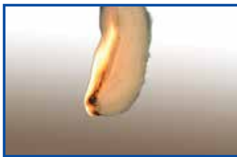
شکل ۳-۶ سوختن الیاف پشم
