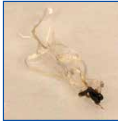
شکل ۵-۳- خاکستر حاصل از سوختن نخ نایلونی
