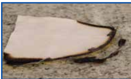
شکل ۲-۱۰ - خاکستر حاصل از سوختن پارچه پنبه‌ای
