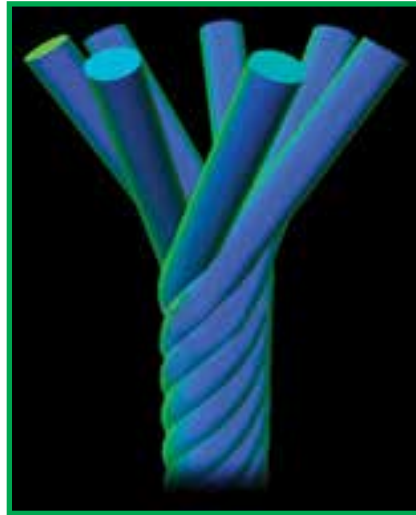
شکل ۶-۶- نحوه تابیدن الیاف به دور یکدیگر
