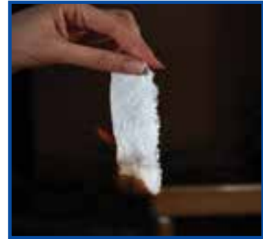
شکل ۴-۳- سوختن پارچه ویسکوز ریون
