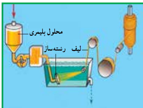
شکل ۱۱-۶- مراحل تولید نخ یک‌سره با روش ترریسی
