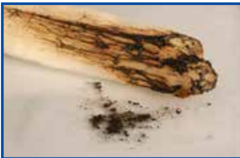
شکل ۳-۷ خاکستر حاصل از سوختن الیاف پشم
