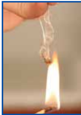
شکل ۵-۲- سوختن نخ نایلون
