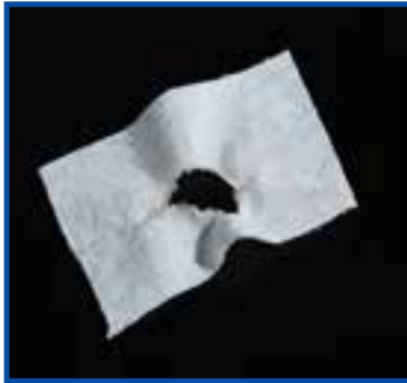
شکل ۴-۵- اثر اسید کلریدریک بر پارچه ویسکوز ریون
