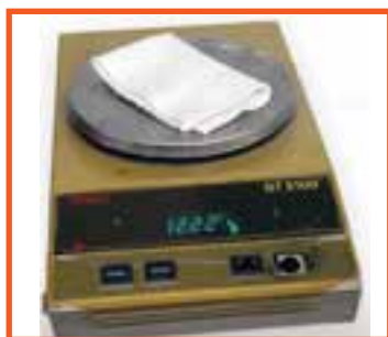
شکل ۱-۱- تعیین وزن پارچه با استفاده از ترازو
