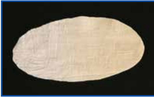
شکل ۲-۵- زرد شدن پارچه پنبه‌ای در دمای ۱۲۰ درجه سانتی‌گراد
