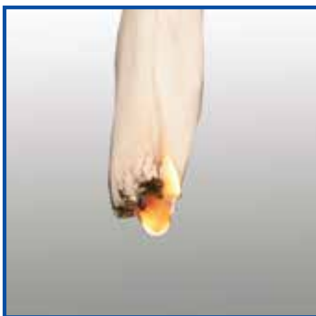
شکل ۵-۱۳- سوختن الیاف اکریلیک
