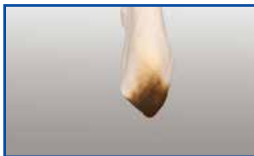
شکل ۲-۹ - سوختن پارچه پنبه‌ای
