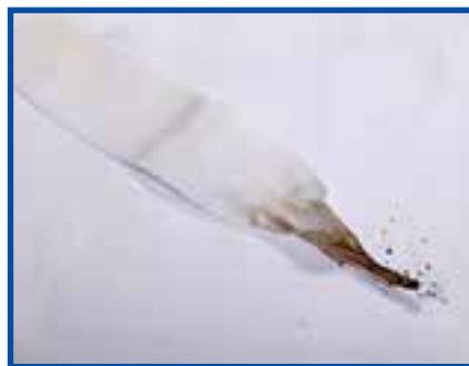
شکل ۹-۴ خاکستر حاصل از سوختن پارچه استات
