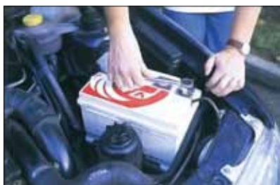
باتری ماشین دارای سولفوریک اسید ( H_2SO_4 ) است که یک اسید قوی می‌باشد.
