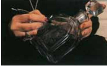
یک هنرمند قلم زن، با استفاده از قلم خود که دارای نوکی از جنس الماس است، بر روی شیشه طراحی می‌کند.
