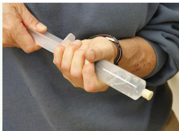
شکل ۱- پدیده جوشش آب در دمای محیط- با آن که آب در دمای محیط است اما در اثر کاهش فشار به جوش آمده است
