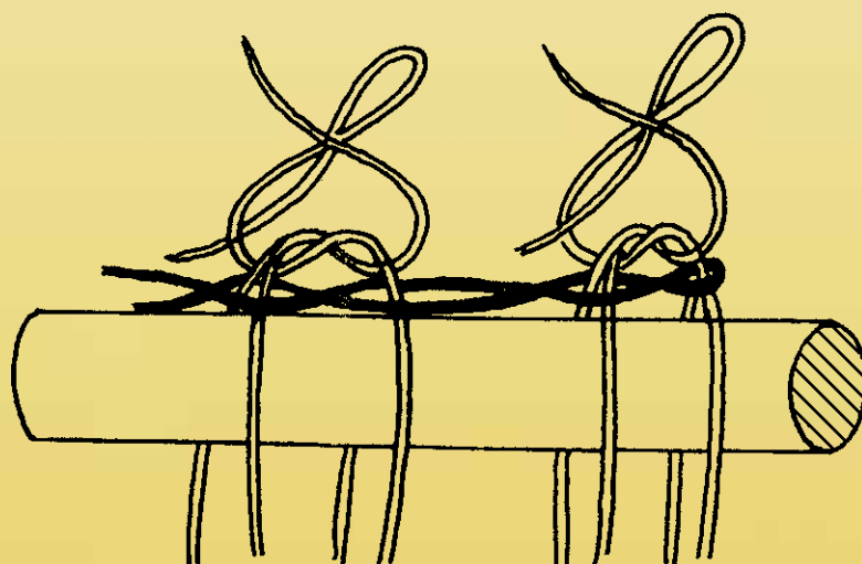
تصویر ۱۲-۱۶- چگونه بستن تارهای چله به سردار
