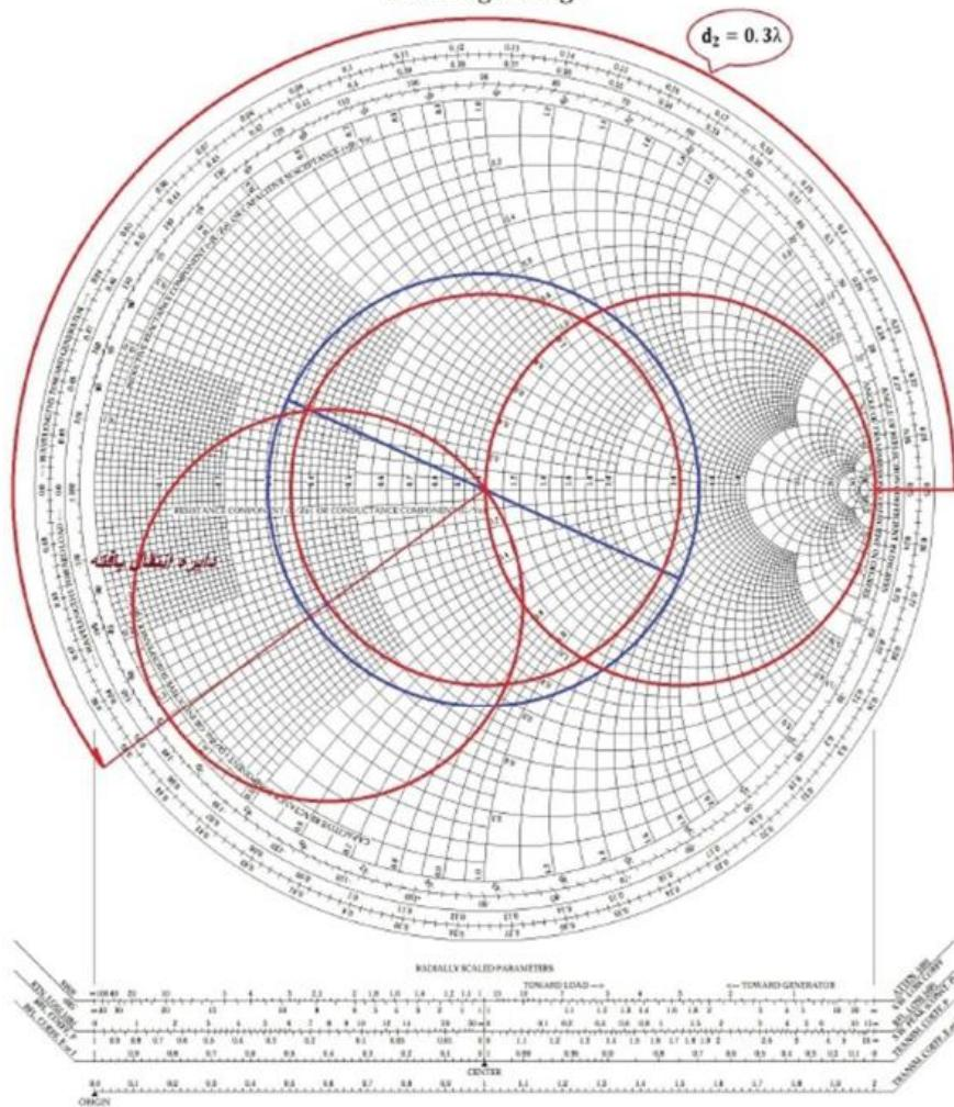
سپس از ( $\bar{y}_L$ ) به اندازه‌ی ( $d_1$ ) ساعتگرد حرکت می‌کنیم و یک خط صاف از مرکز به سمتی که ( $d_1$ ) به آنجا رسیده رسم می‌کنیم، هر جا محور ( $SWR$ ) را قطع کرد آنجا ( $\bar{y}_{d1}$ ) می‌باشد.
