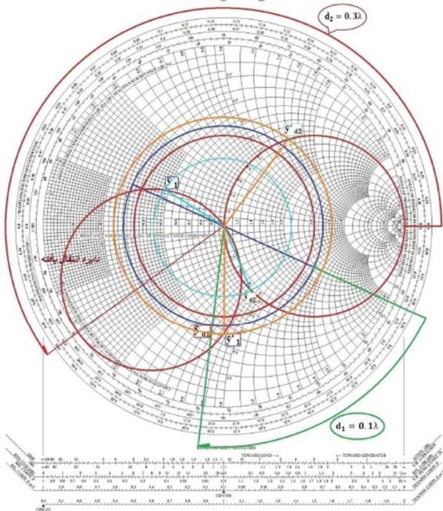
باتوجه به فرمول های مربوطه  $(\bar{Y}'_{s2})$  و  $(\bar{Y}_{s2})$  را بدست آورده سپس مقادیر  $(L'_{s2})$  و  $(L_{s2})$  به صورت ساعتگرد حرکت می کنیم و اندازه ای آن ها را تا  $(\bar{Y}_{s2})$  و  $(\bar{Y}'_{s2})$  یادداشت می نماییم.
