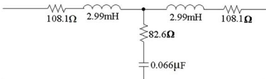
۱۳. عناصر سری یک شبکه T که معادل با یک خط انتقال یکنواخت بطول 5Km در فرکانس  $5000/2\pi$  Hz است هر یک دارای یک مقاومت  $175\Omega$  اندوکتانس  $10mH$  هستند و عناصر موازی شامل خازن سری با مقاومت  $270\Omega$   $0.2\mu F$  هستند. امپدانس مشخصه و ثابت انتشار با داشتن اتحادهای زیر تعیین کنید.
