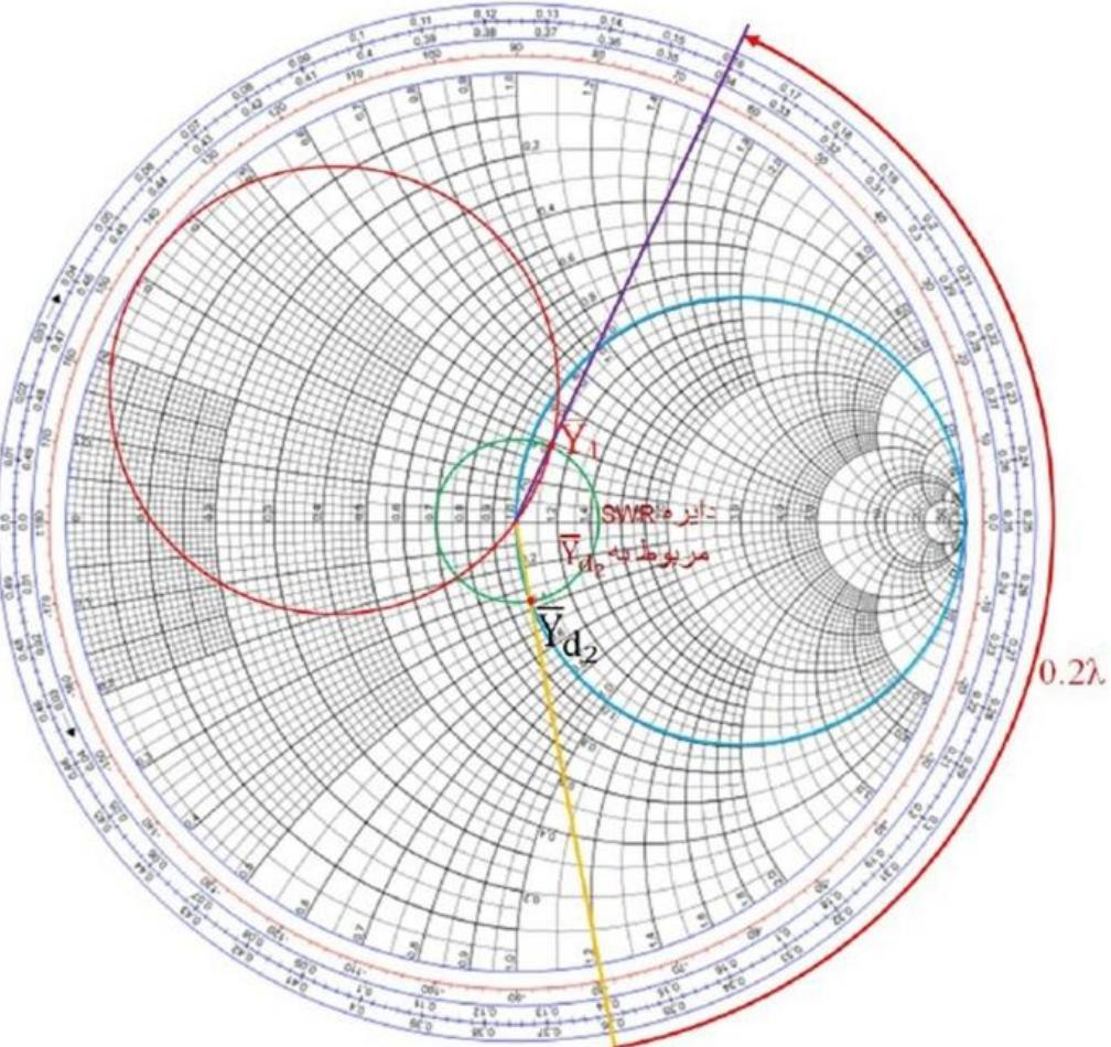
۷- تعیین  $\bar{Y}_{d_1}$  : برای تعیین مقدار  $\bar{Y}_{d_1}$  باید دایره R ثابت مربوط به  $\bar{Y}_1$  را ادامه دهیم تا دایره اصلی SWR (که P و Q روی آن قرار دارند) قطع نماید. با توجه به شکل صفحه بعد دو مقدار برای  $\bar{Y}_{d_1}$  به دست خواهد آمد که عبارتند از:
