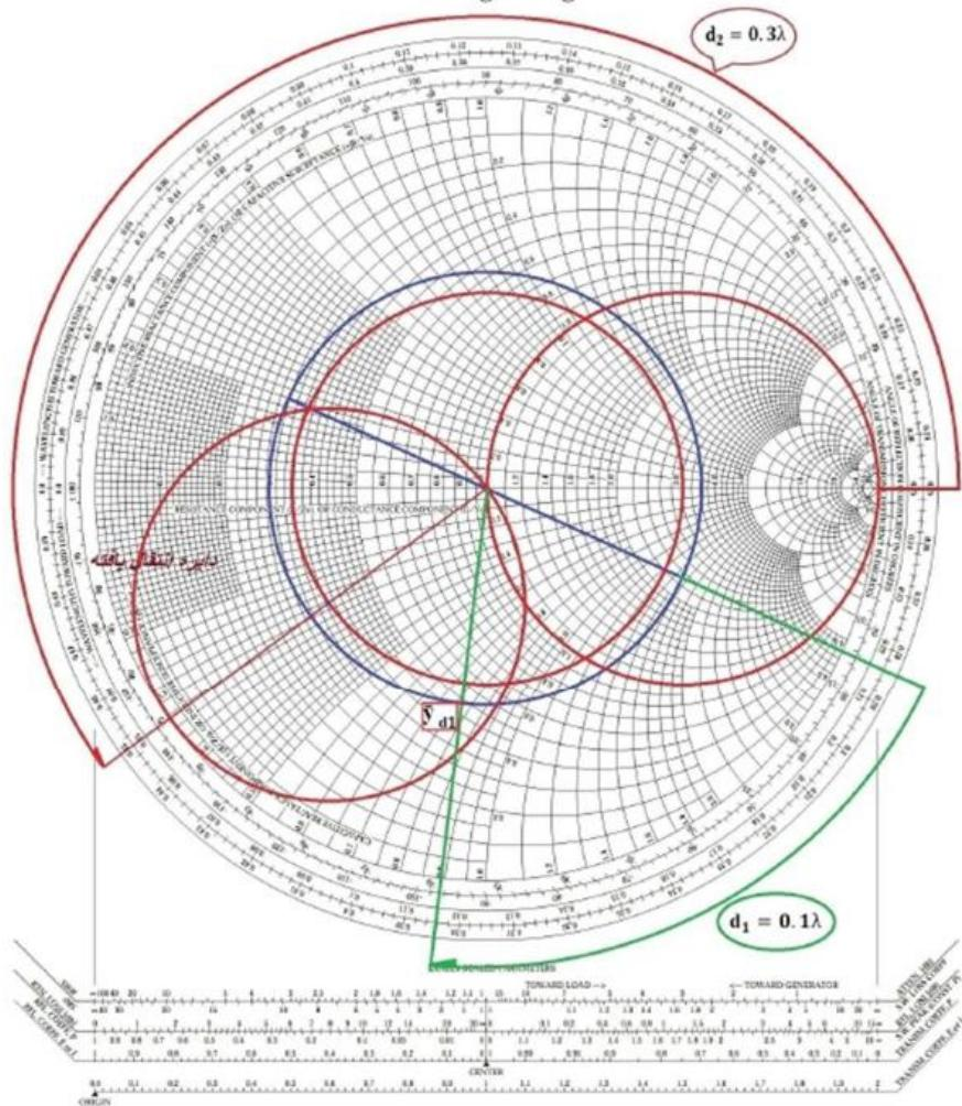
حال به وسیله‌ی مقدار حقیقی ( $\bar{y}_{d1}$ ) روی محور حقیقی حرکت کرده به صورتی که در دو نقطه محور انتقالی را قطع کند این دو نقطه یکی ( $\bar{y}_1$  و دیگری  $\bar{y}'_1$ ) می‌باشد.
