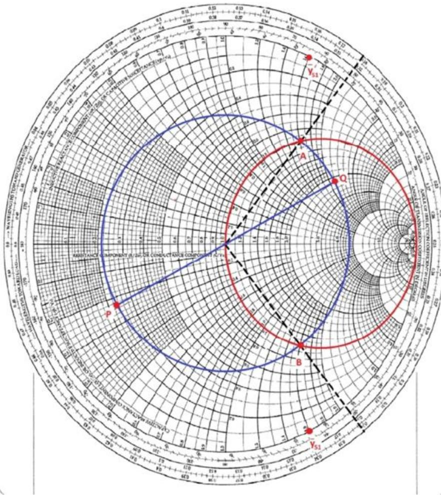
2- امپدانس یک خط انتقال و امپدانس بار  $Z_L$  با مقادیر زیر داده شده است. تطبیق با دو استاب اتصال کوتاه انجام می شود اگر امپدانس مشخصه هر دو استاب  $Z_{01} = Z_{02} = 100$  باشد و استاب اول به فاصله  $\lambda$  از بار قرار گرفته باشد و فاصله دو استاب  $0.2\lambda$  باشد و طول استاب دوم  $0.15\lambda$  باشد، مطلوب است فاصله بار تا استاب اول و طول استاب اول
