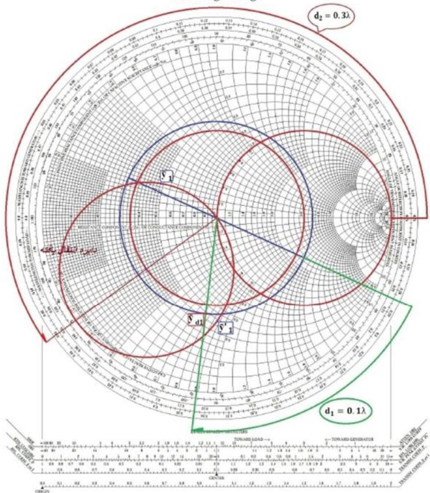
باتوجه به فرمول های مربوطه  $(\bar{Y}_{s1})$  و  $(\bar{Y}'_{s1})$  را بدست آورده سپس مقادیر  $(L_{s1})$  و  $(L'_{s1})$  به صورت ساعتگرد حرکت می کنیم و اندازه ای آن ها را تا  $(\bar{Y}_{s1})$  و  $(\bar{Y}'_{s1})$  یادداشت می نماییم.
