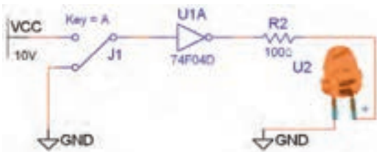
شکل ۳-۱۷۲- مدار گیت منطقی NOT
