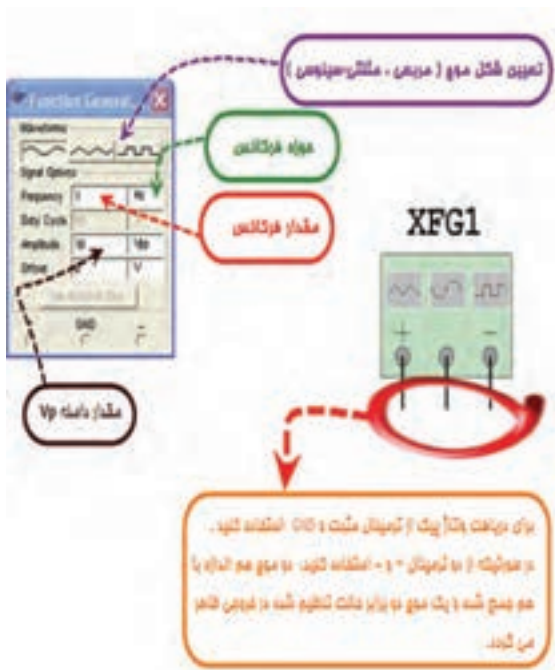
شکل ۳-۵۶ - فانکشن ژنراتور و صفحه تنظیم آن
