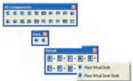
شکل ۳-۱۲۲ - قرار دادن دیود بر روی میز کار مجازی
