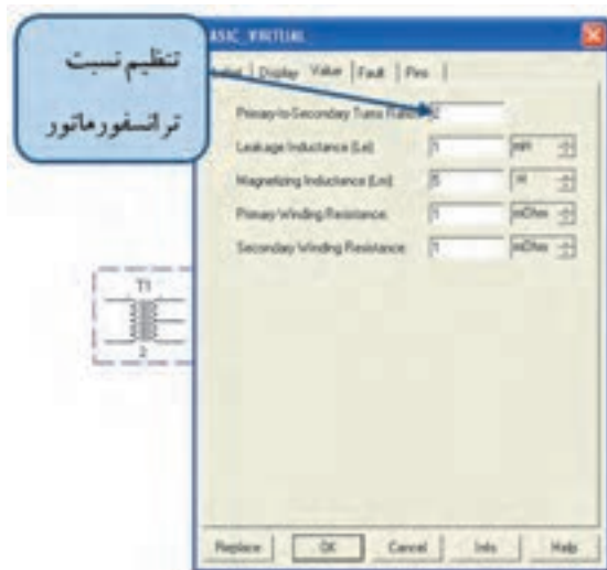
شکل ۳-۱۰۸ - تنظیم نسبت ترانسفورماتور
