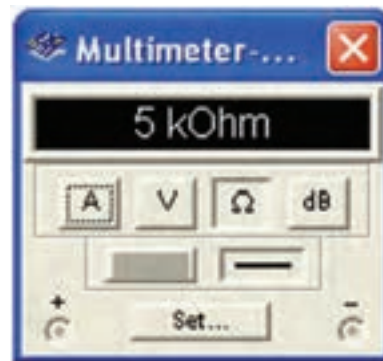
شکل ۳-۷۲ - اندازه‌گیری مقاومت کل در مدار سری
