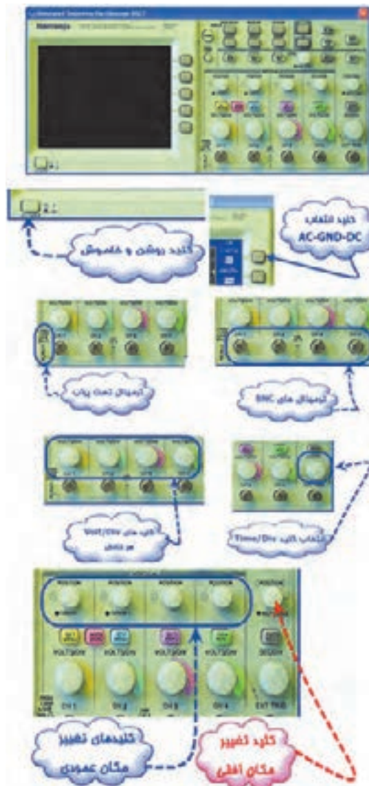
شکل ۱۱۱-۳- دکمه‌های دستگاه اسیلوسکوپ سه بعدی
