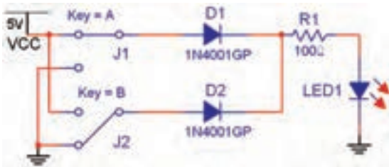
شکل ۱۵۸-۳ - مدار دیودی گیت OR
