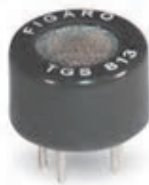
شکل ۴-۲ - سنسور گاز و لیست قطعات مدار
