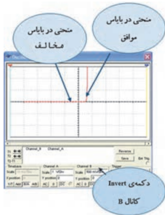
شکل ۱۲۷-۳- منحنی مشخصه دیود در بایاس موافق و مخالف
