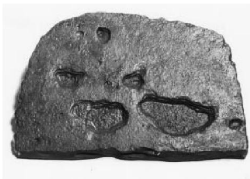
شکل ۲: خوردگی بدنه کشتی توسط SRB پس از تنها ۹ ماه
